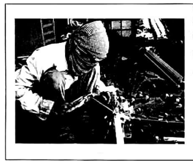
សំណាមាធសិក្ខណៈភាពរលាយទាបប្រើសម្រាប់ផ្សារលោហៈ
